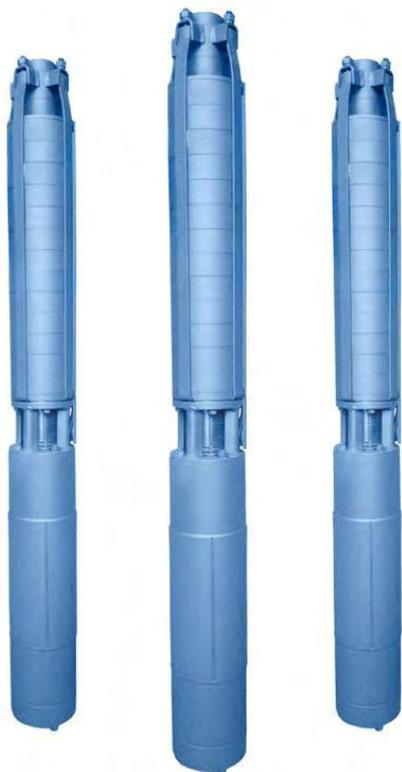
Предназначены для подъема чистой воды, с массовой долей твердых механических примесей – не более 0,01% с размером 0,1 мм, из артезианских скважин, с целью водоснабжения промышленных, дачных, садовых зон, жилых массивов, предприятий ЖКХ, объектов сельского хозяйства, а так же орошений. Поддачи агрегатов от 2,5 до 255 м<sup>3</sup>/ч, с напором до 400 м для 4,5,6,8,10,12 дюймовых скважин.
